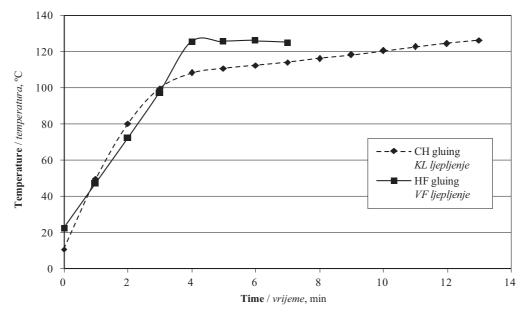
Figure 2 Dependence of temperature in the middle of the specimen on gluing procedure time Slika 2. Ovisnost temperature u središtu uzorka o trajanju procesa lijepljenja
