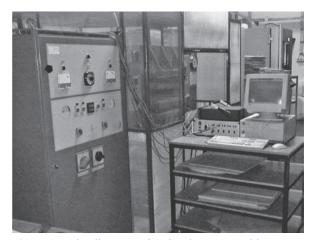
**Figure 1** Hydraulic conventional and HF press with a device for measuring temperature **Slika 1**. Klasična hidraulična preša i visokofrekventna preša s uređajem za mjerenje temperature
